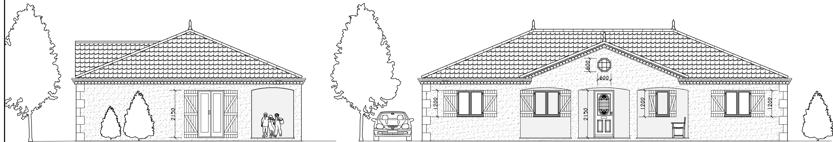
Facade Ouest ( echelle 1:100 ) Couverture en tuiles de couleur brune/beige Murs en parpaing enduit, de couleur beige Menuiseries bois moyens carreaux de couleur blanche
